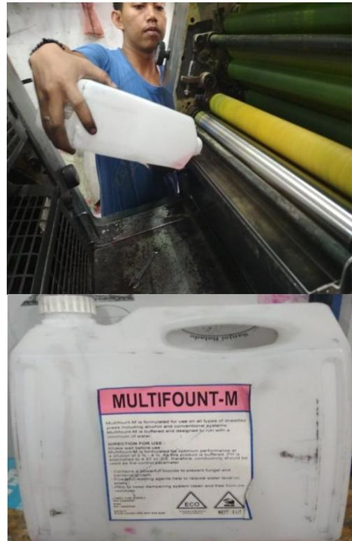
**Gambar 3.** Pencampuran Larutan Pembasah Yang Cukup
