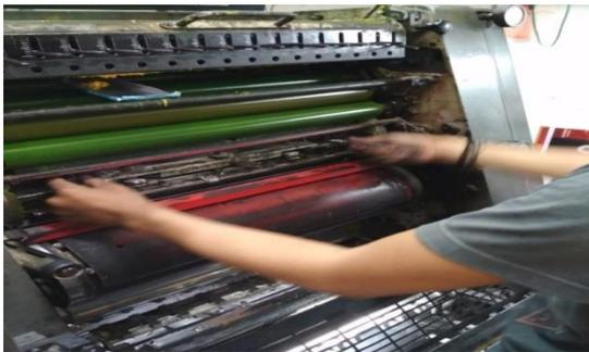
**Gambar 5.** Penyetelan Posisi Pelat Cetak Yang Tepat
