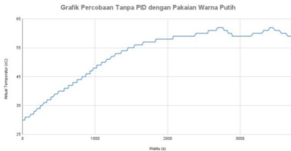
Gambar 17 Grafik Percobaan Tanpa PID dengan Pakaian Warna Putih Sumber: Dokumen Pribadi
