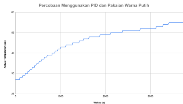
Gambar 21 Grafik Percobaan Menggunakan PID dengan Pakaian Warna putih Sumber: Dokumen Pribadi
