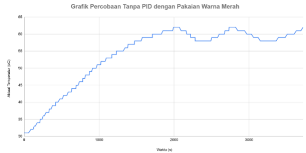
Gambar 18 Grafik Percobaan Tanpa PID dengan Pakaian Warna Merah Sumber: Dokumen Pribadi
