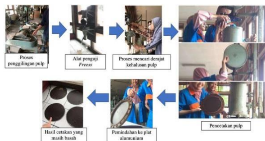
Gambar 2. Proses Penggilingan dan Pencetakan Pulp Hingga Menjadi Lembaran Kertas
